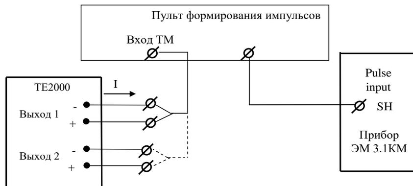
Значение  $I$  не должно превышать 30 мА и определяется нагрузкой по входу ТМ измерительной установки
