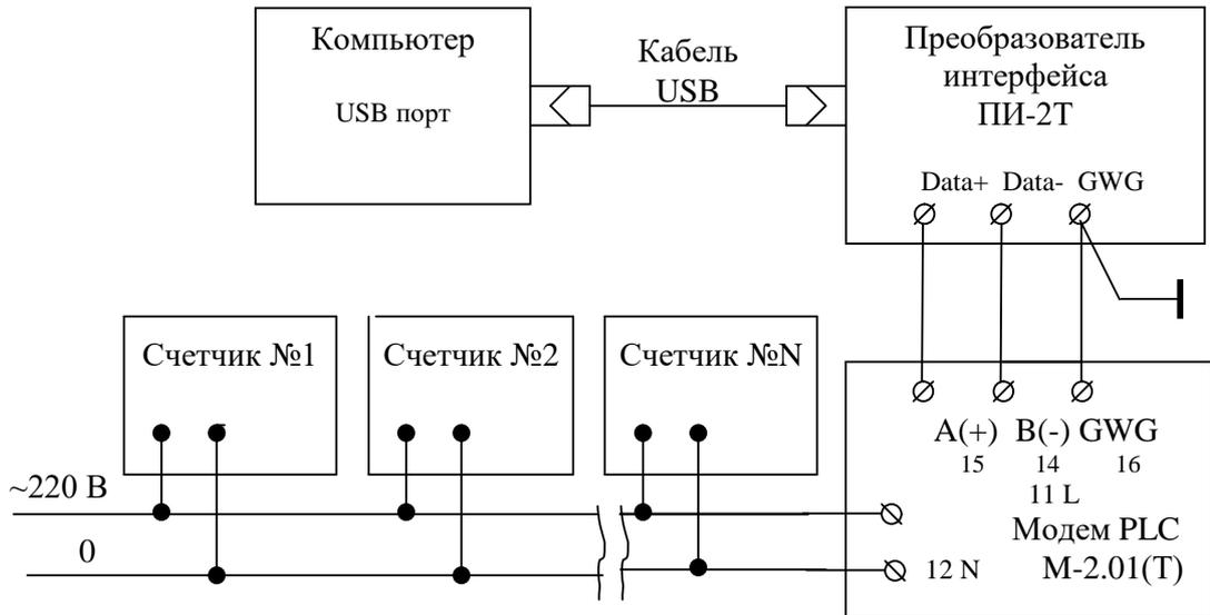
Примечание – В данной схеме PLC-модем М-2.01(Т) используется как базовая станция, к которой должны подключаться PLC-модемы счётчиков.
