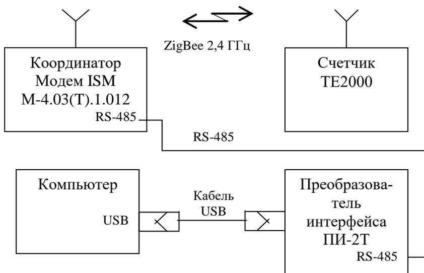
Рисунок В.7 - Схема подключения счётчика с ZigBee-модемом к компьютеру через координатор M-4.03(T).1.012
