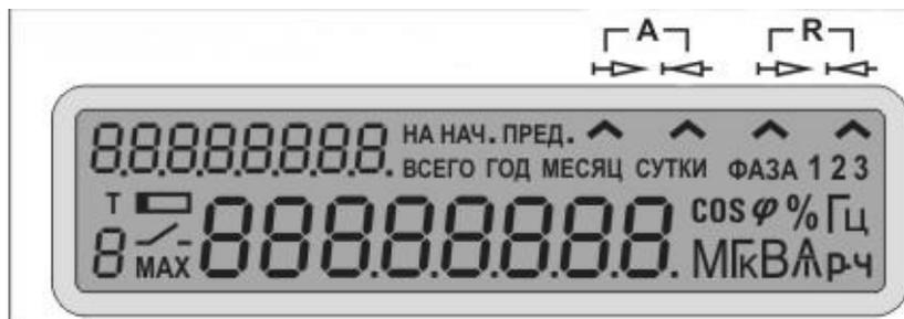
Рисунок 6 - Внешний вид ЖКИ счетчиков для установки на DIN-рейку с включенными элементами индикации
