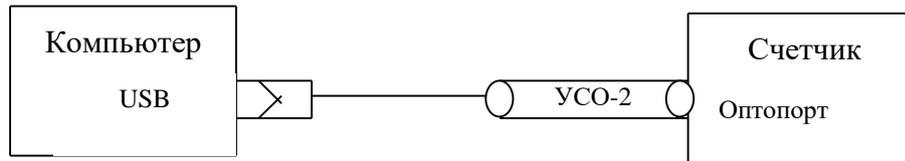
Рисунок В.2- Схема подключения счетчика к компьютеру через оптопорт
