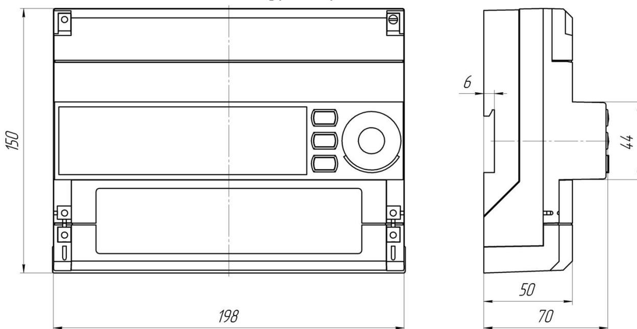
**Рисунок А.3 – Габаритный чертеж и установочные размеры счётчика для установки на Din-рейку**
