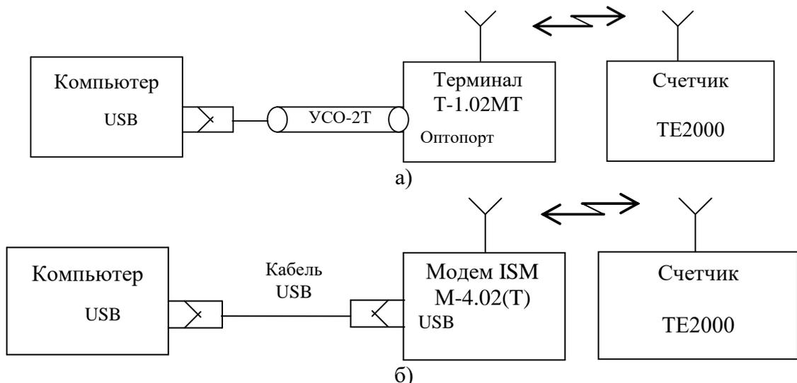
Рисунок В.4 - Схема подключения счётчика к компьютеру через терминал или радиомодем
